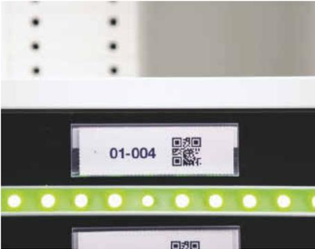
*Alle Teile komplett? LED-Streifen am Regal zeigen die Positionen der Teile an, die bereit für die Montage sind.*
