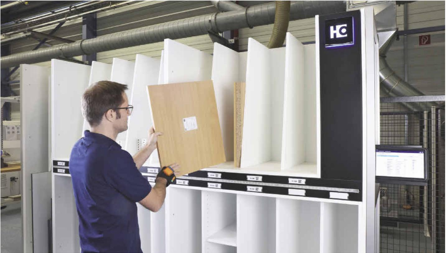
*/ Transparenz über alle Teile in der Werkstatt: Der Sortier-Assistent hilft dabei, alle Bauteile Korpus für Korpus zu sortieren und für die Montage vorzubereiten.*
