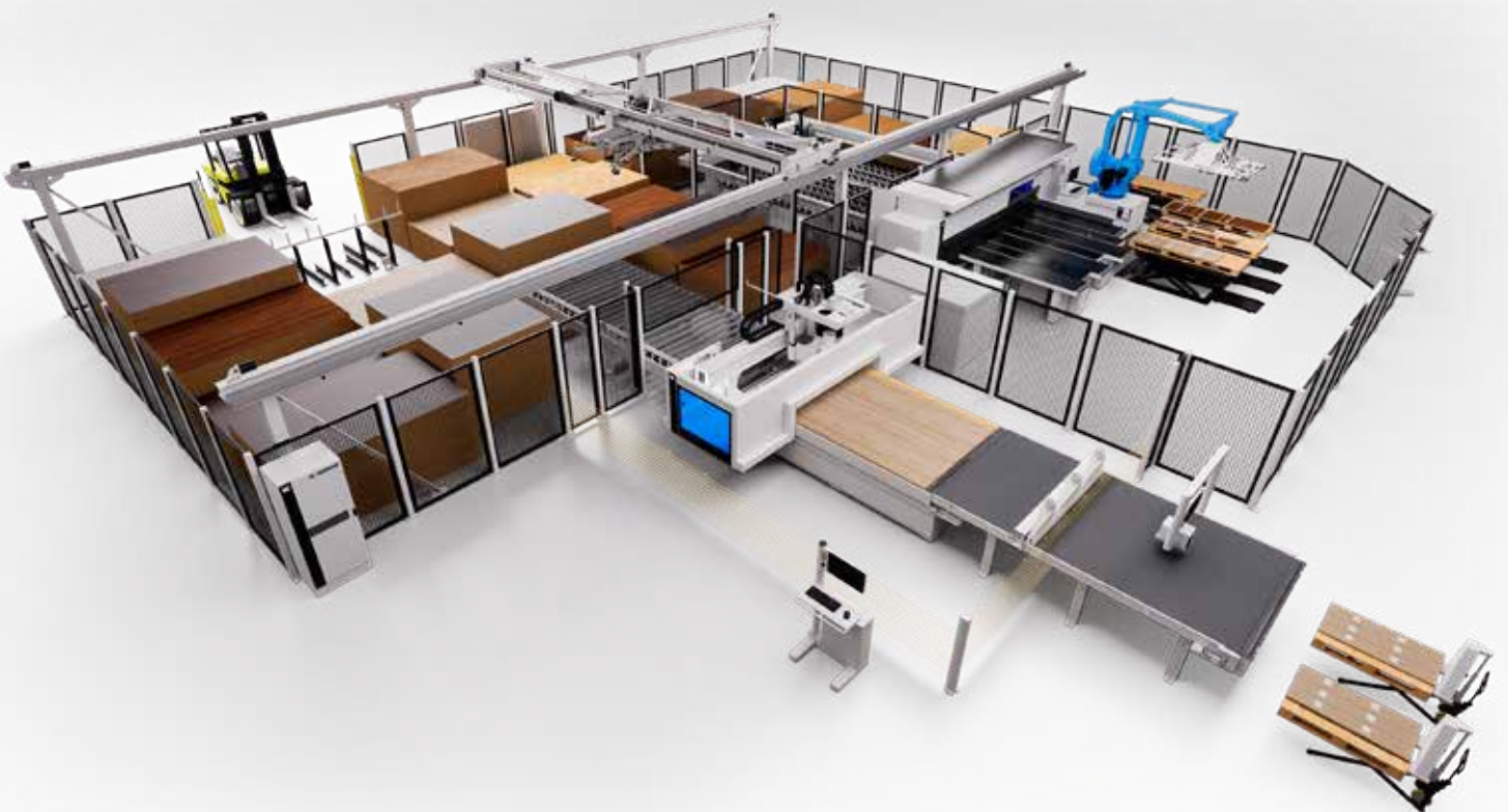
Empilage par robot inclus
